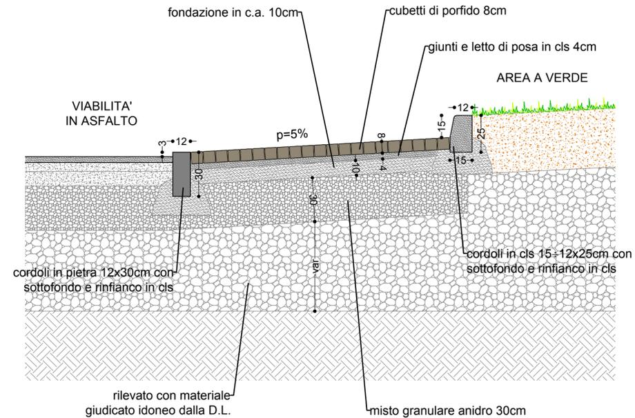
N.B. IL RILEVATO DERIVANTE DALLA MODELLAZIONE DEL TERRENO ANDRA' VERIFICATO COME RESISTENZA AL CARICO (PROVE SU PIASTRA) PRIMA DI ESEGUIRE I PACCHETTI DI PAVIMENTAZIONI
