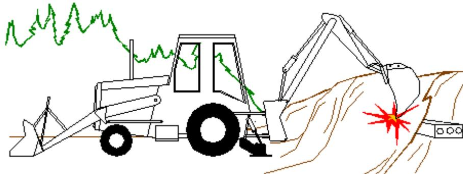
Figura 1 - Contatto con linee elettriche interrato
