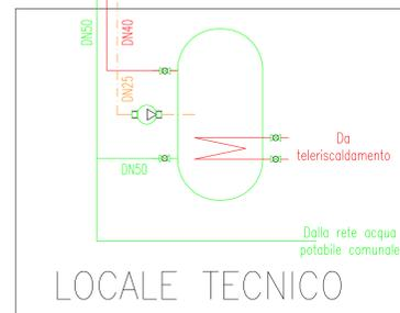
SCHEMA ALTIMETRICO IMPIANTO IDRICO-SANITARIO
