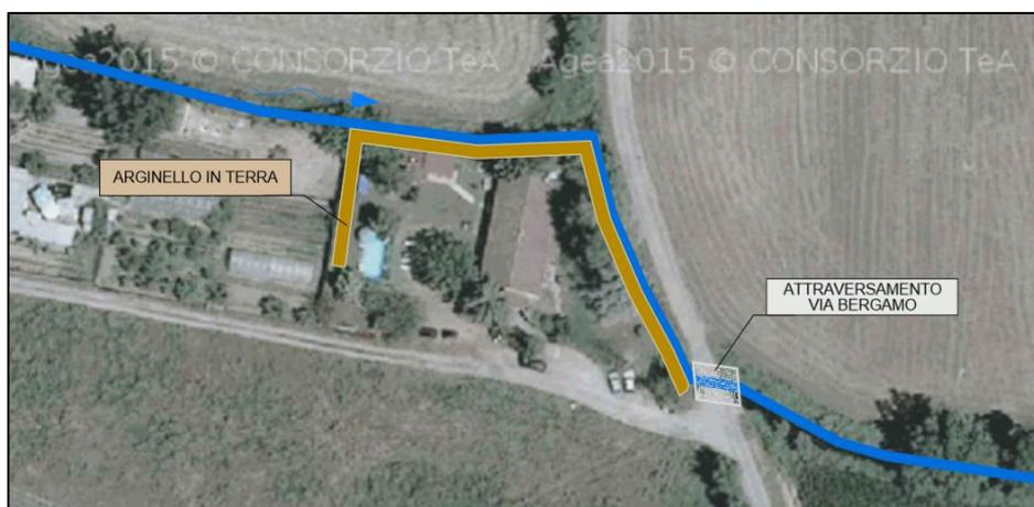
Figura 14 - Traccia planimetrica dell'arginello in terra (Intervento A)
