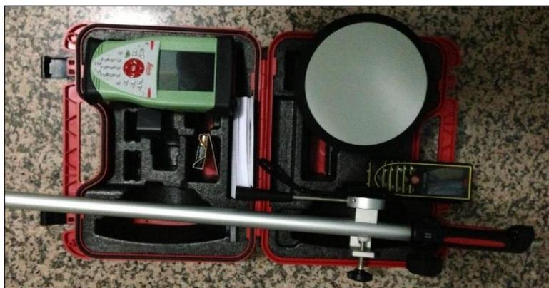
*Figura 2 – Antenna GPS utilizzata per il rilievo topografico.*
