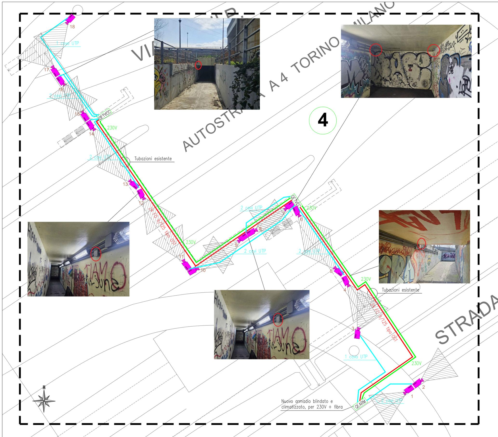
Nuovi cavidotti interrati in polietilene HD PE doppia parete interna liscia con sonda in nylon/inox, profondità di posa 80 cm, ricoperta con calcestruzzo
