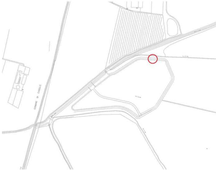
Fig. 6 – Bacino di Laminazione dello Scolmatore Ovest – punto di superamento dell'argine
