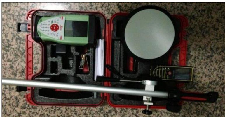
*Figura 4 – Antenna GPS utilizzata per il rilievo topografico*
