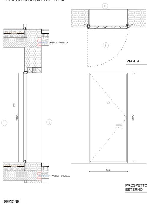
**TIPOLOGIA NR. 6 - PORTEMULTIFUNZIONE AD UN BATTENTE CIECO (CON TELAIO, GRIGLIE DI AERAZIONE E SERRATURA)**
