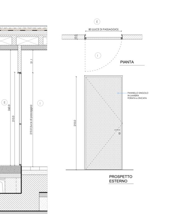
**TIPOLOGIA NR. 7 - PORTEMULTIFUNZIONE AD UN BATTENTE CIECO (CON TELAIO, GRIGLIE DI AERAZIONE E SERRATURA)**
