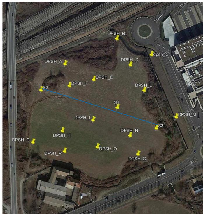
Figura 6: Planimetria dell'area con indicazione delle verticali di indagine e traccia della sezione litostratigrafica di Figura 7 (linea blu)
