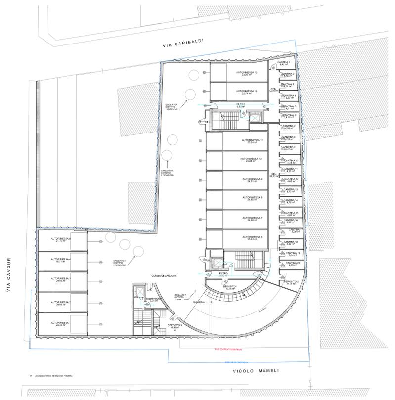
PIANTA PIANO INTERRATO CON LA VERIFICA DELL'ACCESSIBILITA' DELLE PARTI COMUNI scala 1:200
