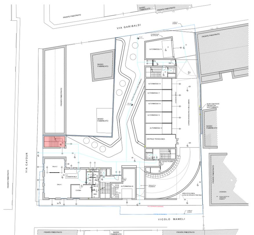
PIANTA PIANO TERRA CON LA VERIFICA DELL'ACCESSIBILITA' DELLE PARTI COMUNI scala 1:200
