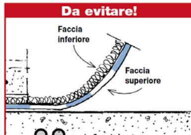
Lo strato isolante dovrà supportare il traffico di cantiere, dovrà essere costituito da materiali durevoli e imputrescibili. Posare i rotoli conforme il naturale senso di svolgimento, rispettando la disposizione della faccia inferiore (in basso) e superiore (a vista) indicato per ogni tipo di FONOSTOP (o similari). *FONOSTOP posato al rovescio si impregnerebbe di malta, perdendo così il potere isolante.*
