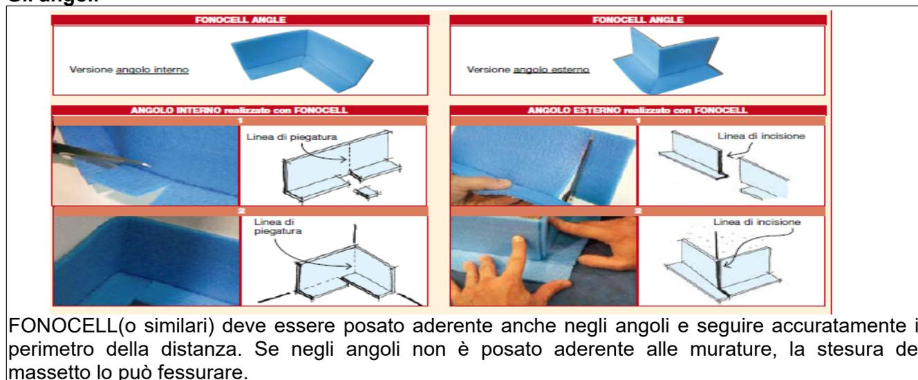
FONOCCELL(o similari) deve essere posato aderente anche negli angoli e seguire accuratamente il perimetro della distanza. Se negli angoli non è posato aderente alle murature, la stesura del massetto lo può fessurare.
