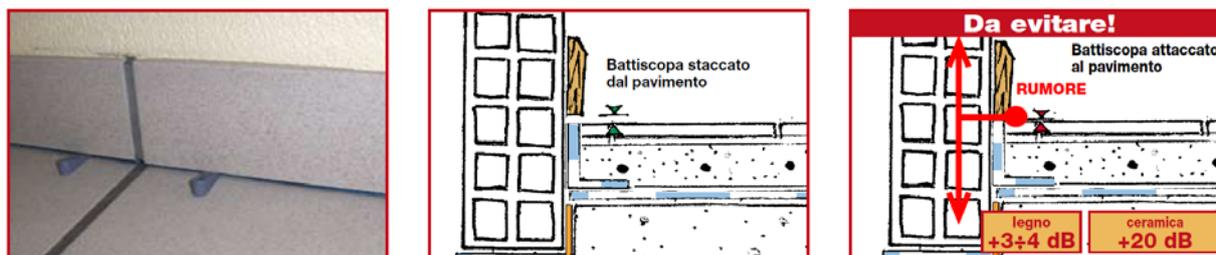
Il battiscopa deve essere posato staccato dalla pavimentazione. *Un eventuale contatto del battiscopa con il pavimento causerebbe un ponte acustico danneggiando la riuscita dell'isolamento acustico nell'entità di 3 – 4 dB nel caso in cui il battiscopa fosse in legno, ma addirittura di 20 dB nel caso di contatto tra pavimento e battiscopa ceramico.*
