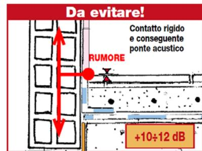
Dopo aver posato i battiscopa o il rivestimento ceramico staccato dalla pavimentazione si potrà disporre un cordolo di sigillatura elastica. *Anche in questa ultima fase è da evitare la creazione di contatti rigidi con il pavimento che causerebbe un ponte acustico che penalizzerebbe l'isolamento.*
