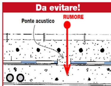
Accostare con cura le teste dei teli evitando di sovrapporre. *Un accostamento imperfetto causerebbe un ponte acustico riducendo l'isolamento.*
