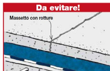
Stendere sempre massetti cementizi armati. l'armatura del massetto sarà costituita da una rete metallica elettrosaldata zincata con maglia di 5x5 cm circa, o da armature di prestazioni analoghe. *La mancanza dell'armatura può causare la rottura del massetto e possibili penalizzazioni delle prestazioni.*
