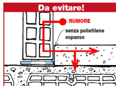
Isolare il sottofondo dai muri con delle strisce adesive di polietilene espanso di 2-3 mm di spessore e di 1-2 cm più alta del sottofondo. *La mancanza della striscia aumenta la trasmissione laterale dei rumori.*
