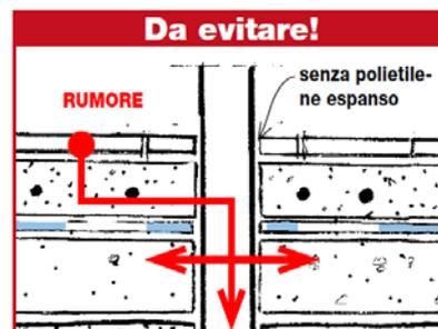
Fasciare le tubazioni che attraversano il solaio con strisce adesive di materiale elastico. *Un tubo non isolato trasmette il rumore.*
