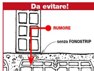
Il solaio che costituisce l'elemento portante in genere è costituito da latero-cemento. Su di esse verranno predisposte le strisce isolanti sulle quali verranno elevate le pareti divisorie. Per esempio FONOSTRIP marca INDEX (o similare) è l'isolante elastomerico, fornito in strisce di diversa altezza, in grado di smorzare le vibrazioni delle pareti. *Un muro non isolato aumenta le trasmissioni laterali del rumore.*
